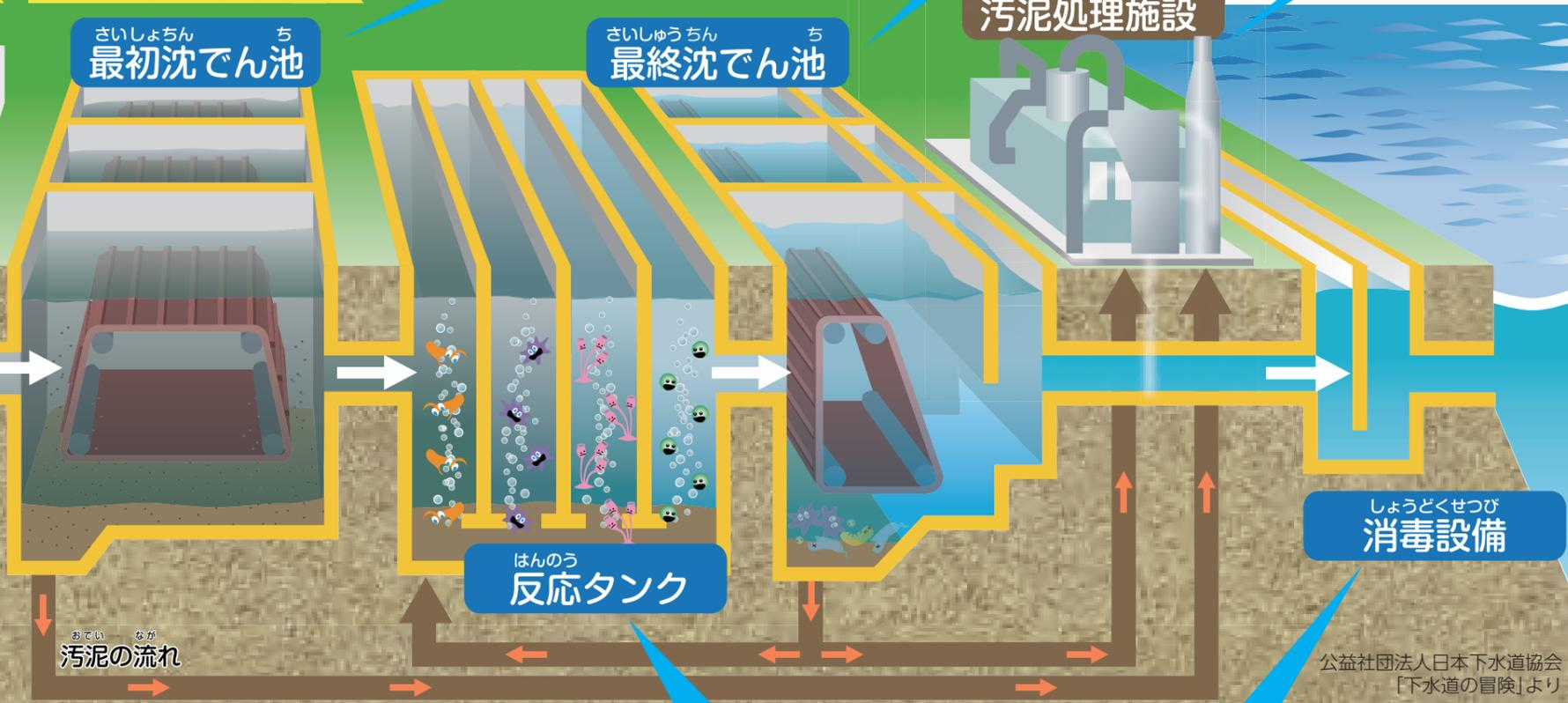
最も汚れた状態の水で臭いも強いですが、2時間かけてゆっくりと汚水を流すことで、大きなごみや石、砂や細かい汚れを沈ませて取り除きます。最初沈でん池から反応タンクを通し、最終沈でん池へ処理を進めていく過程で徐々に臭いが薄くなり、水もきれいになっていきます。
