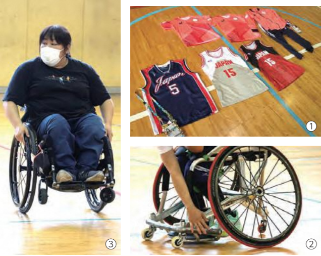
①アテネパラリンピック(左)、東京パラリンピック(右)出場時のユニフォームとIDカード ②車いすバスケット用の車いすでは、接触してもケガしないようにパンパーが付いている。 ③段差などを超えるために日常生活は後ろに車輪がないが、車いすバスケットは広範囲のボールがとれるように付いている。
