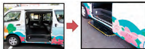
電動ステップ設置
