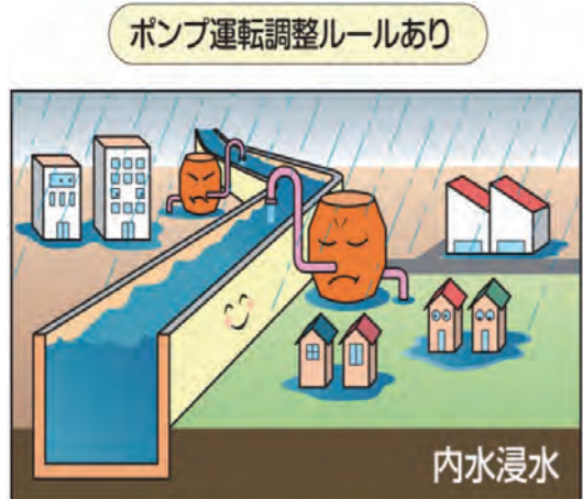
ポンプ運転調整(河川水位低下)により破堤を回避
