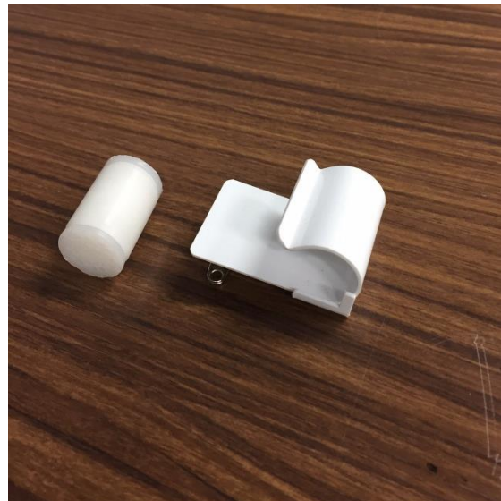
窒素酸化物簡易測定用の器具取り付けの様子及び測定用器具
