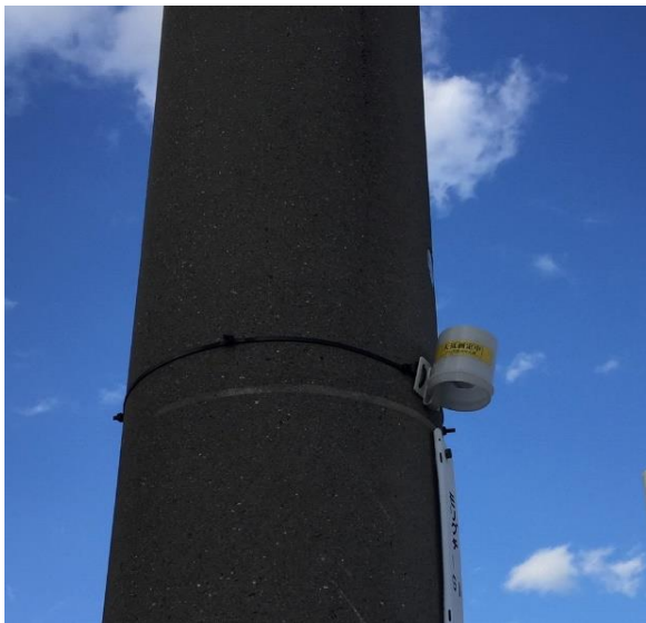
窒素酸化物簡易測定用の器具取り付けの様子及び測定用器具
