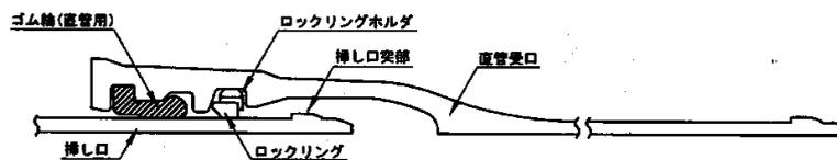
図-5-7-31 直管継手構造図
