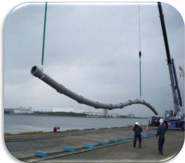
耐震管の曲げ実験風景
