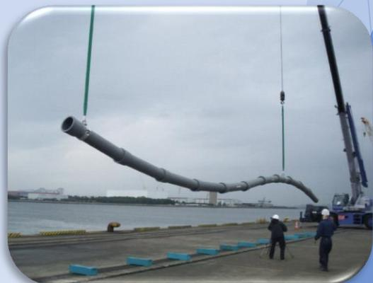
耐震管の曲げ実験風景
