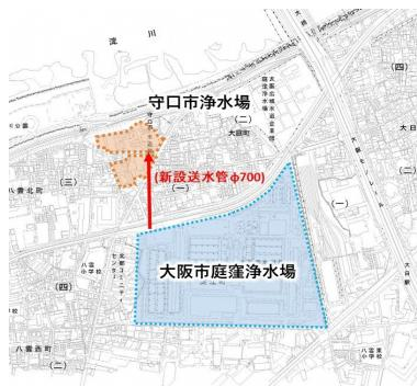
庭窪浄水場で製造した水を本市浄水場の主要配水池へ送水するため、新たに送水管(計画口径φ700、延長約650m)を布設します。庭窪浄水場で製造した水による運用の開始後、守口市浄水場は水づくりの施設のみ停止した状態で、順次、配水場施設に再構築を行う計画です。共同化対象範囲は、イメージ図に示すとおりです。この部分のうち、守口市の施設能力の割合分の資産を大阪市から購入し、保有するものです。
