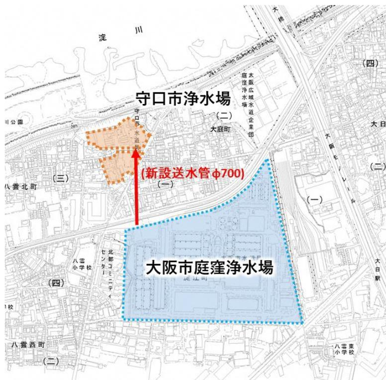
庭窪浄水場で製造した水道水は、表-18のとおり本市浄水場へ送水するため、新たに送水管(計画口径φ700、延長約650m)を布設する計画です。送水管は、本市浄水場の主要配水池へ連絡し、庭窪浄水場で製造した水により運用することとなります。以後、本市浄水場施設のうち水づくりの施設のみ停止した状態で、運用しながら、順次配水場施設に再構築を行なう計画です。
