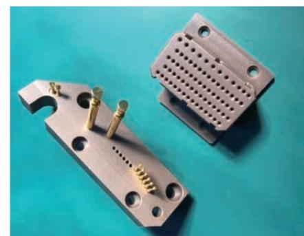
プローブピン挿入併せ加工品サンプル
