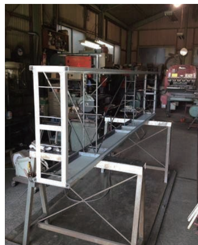
製作中の看板フレーム
