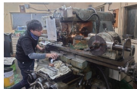
横フライスにてミーリング加工作業
