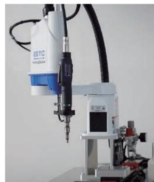
ねじ締め専用ロボット ESTIC ROBOT SYSTEM
