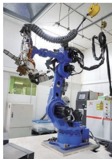
ファイバーレーザー溶接ロボット
