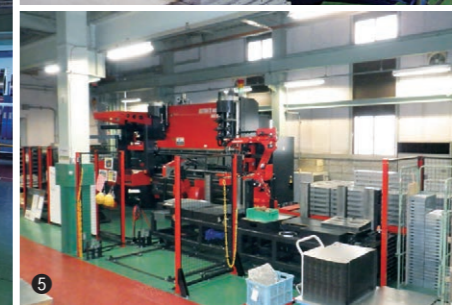
① 田辺工場で金属加工もカバー ② 企画の段階から顧客に入り込む ③ 内製化した塗装工程 ④ 金属加工でも自動化を進める ⑤ ファイバーレーザー溶接を導入
