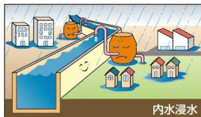
ポンプ運転調整（河川水位低下）により破堤を回避
